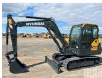
HX55S 작동 무게 : 5.560Kg 버킷 용량 : 0.18 m 3 정격 전력 : 36.2kw/2200rpm
