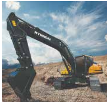
Excavator HX340SL 작동 무게 : 33 ton 버킷 용량 : 2.3 m 3 정격 전력 : 260hp/2,200rpm
