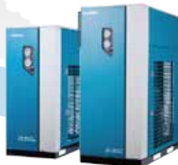
AD-HT 시리즈 (일체형 드라이어) 에프터 쿨러, 에어필터, 에어 드라이어 일체형으로 설치면적 최소화. 입구온도 80°C 설계로 더운 동남아 지역에 최적화.
