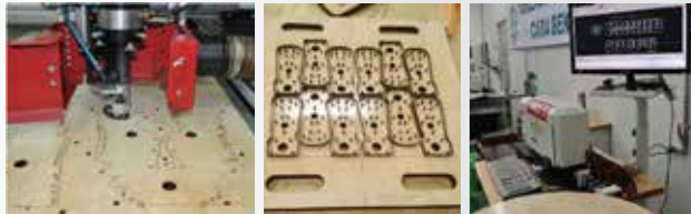
철판,아크릴, 합판, 빼그라이트등 레이저커팅
