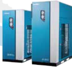
AD-HT 시리즈 (일체형 드라이버) 에프터 쿨러, 에어필터, 에어 드라이버 일체형으로 설치면적 최소화. 입구온도 80°C 설계로 더운 동남아 지역에 최적화.
