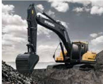
Excavator HX210S 작동 무게 : 20.83 ton 버킷 용량 : 0.92 m 3 정격 전력 : 148hp/2000rpm
