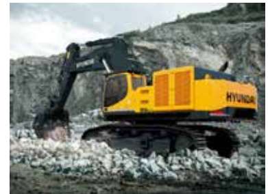
Excavator R850LC-9 작동 무게 : 84 ton 버킷 용량 : 5.2 m 3 정격 전력 : 510hp/1800rpm
