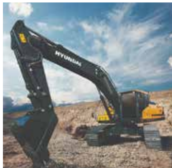
Excavator HX340SL 작동 무게 : 33 ton 버킷 용량 : 2.3 m 3 정격 전력 : 260hp/2,200rpm
