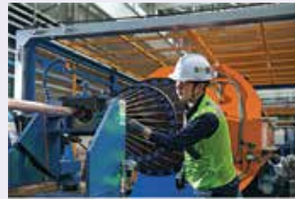
▲ LS전선 동해 공장에서 해저케이블을 생산하는 모습. (사진=LS전선)
